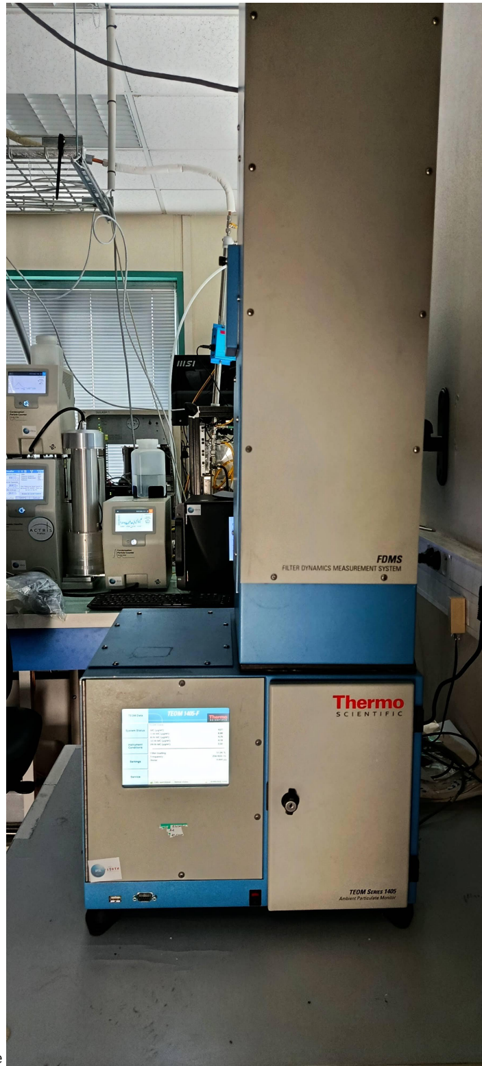
TEOM à la station SIRT-Orme
