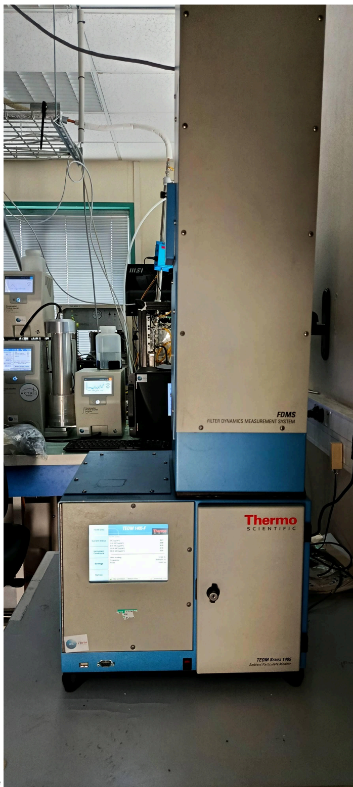
TEOM à la station SIRT-Orme
