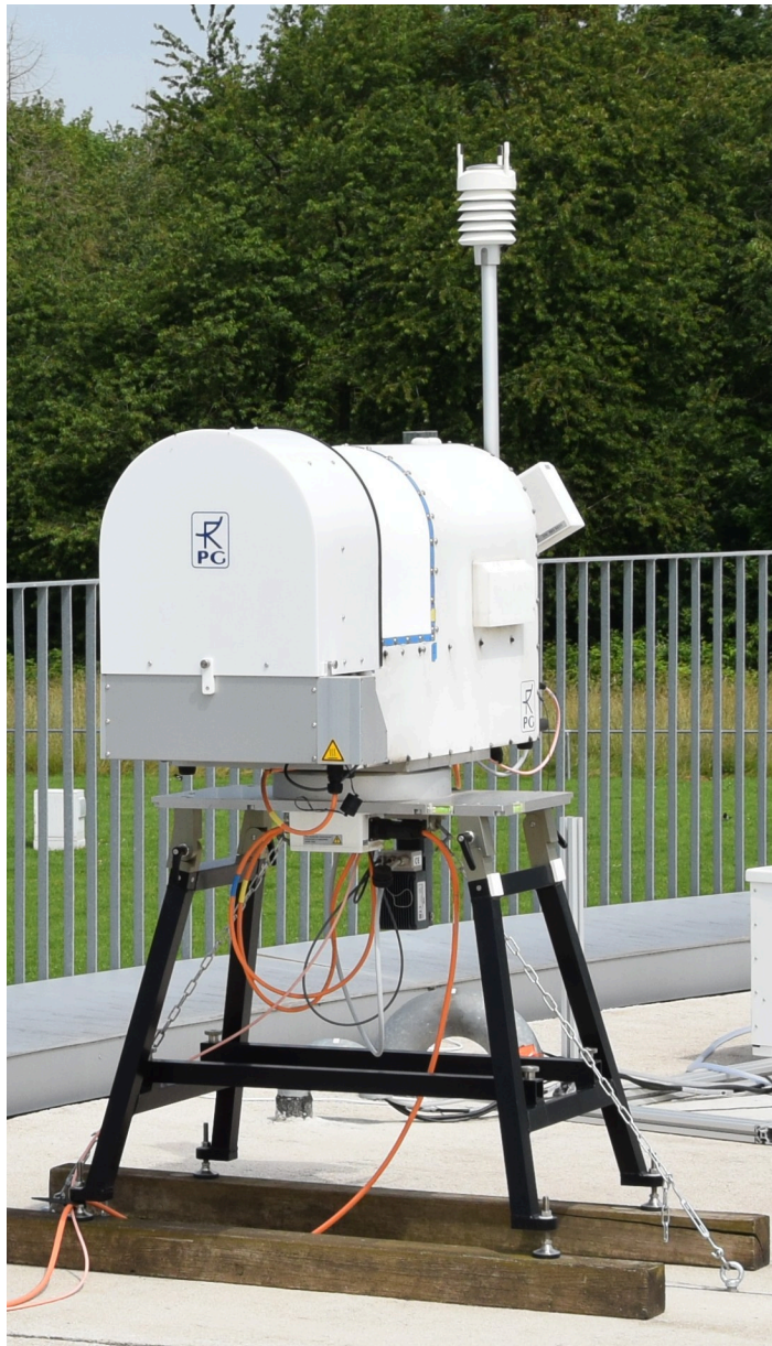
Radiomètre micro-ondes Hatpro G5 sur le toit de l'observatoire SIRTA
